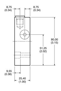
\* - 6,35 (0.25) 外径管 G<sup>1</sup>/<sub>4</sub> (公制) .435-20 UNF-2B 螺纹 (英制)
